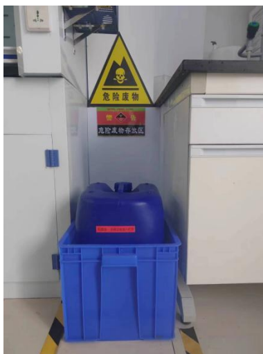
图 3-3 实验废液收集设施
