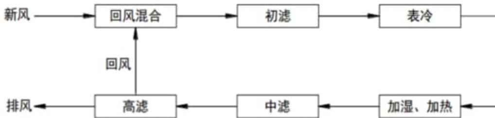
图 3.1-2 空调净化系统流程图
