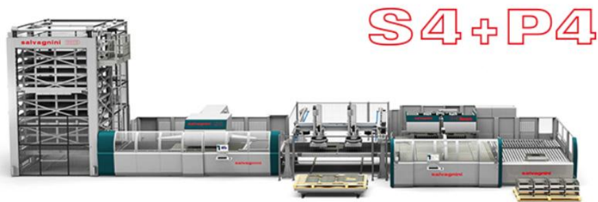
图 5-3 S4+P4 全自动柔性钣金生产线
